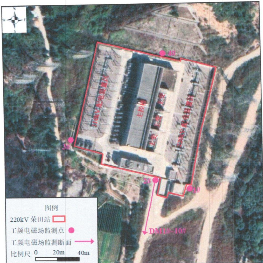
图1 220kV 荣田站工频电磁场监测布点图
