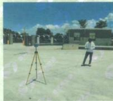
110kV 线路电磁衰减断面监测
