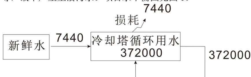
图 1 水平衡图 (单位: m<sup>3</sup>/a)
