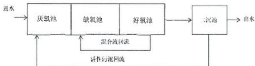
图 4-1 磐东污水处理厂处理工艺流程图
