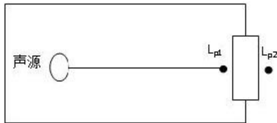
图 4-2 室内声源等效为室外声源图例
