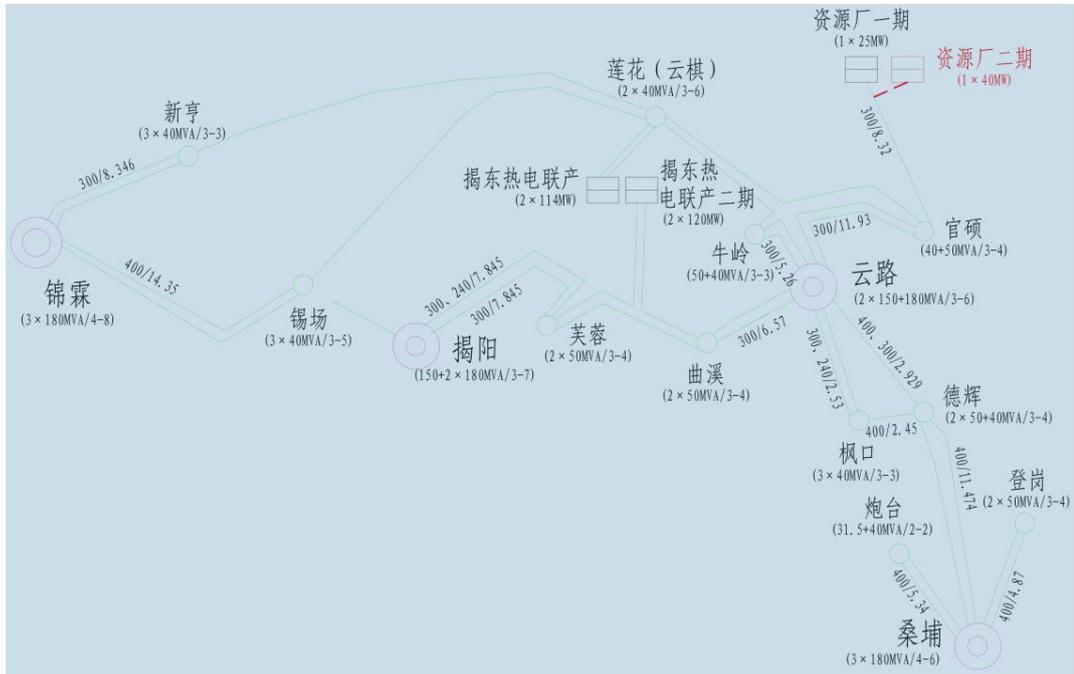
图 2.2-1 本项目投产后近区电网接线示意图
