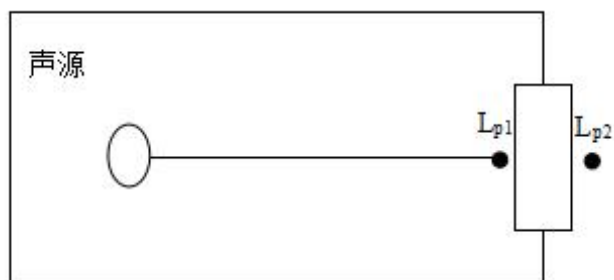
图4-1 室内声源等效为室外声源图例
