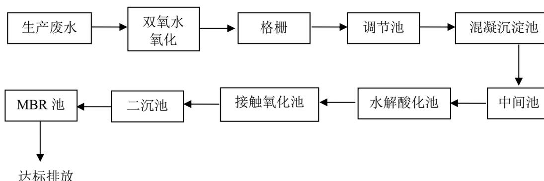
图 4-1 自建污水处理设施工艺流程图
