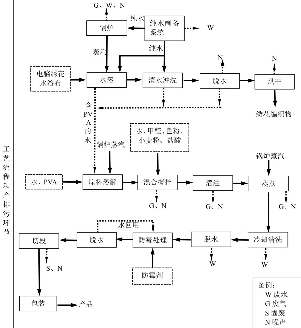
图 2-2 项目工艺流程图
