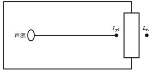
图 4-1 室内声源等效为室外声源图例
