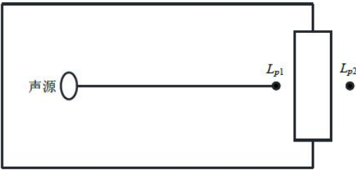
图 4-1 室内声源等效为室外声源图例
