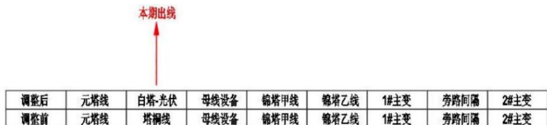
图 2.3-2 110kV 白塔站 110kV 侧出线示意图
