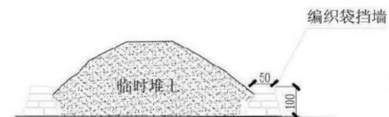
临时堆土防护设计示意图
