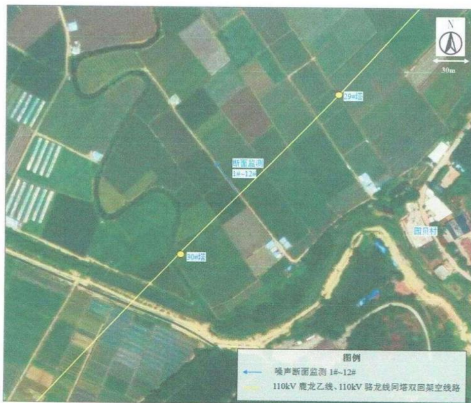
图 1 惠州 110kV 鹿龙乙线、110kV 骆龙线同塔双回架空线路噪声监测断面示意图
