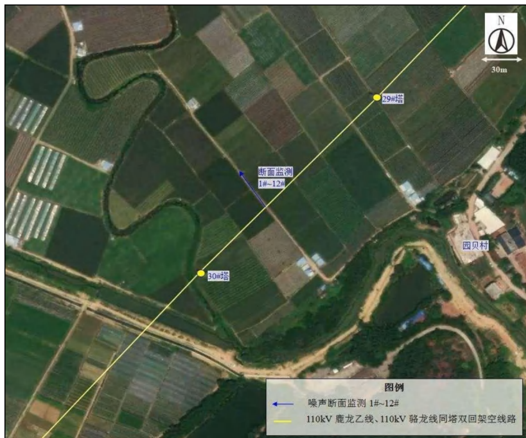
图 4.2-1 同塔双回架空线路噪声类比监测布点图
