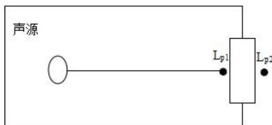
图 4-1 室内声源等效为室外声源图例
