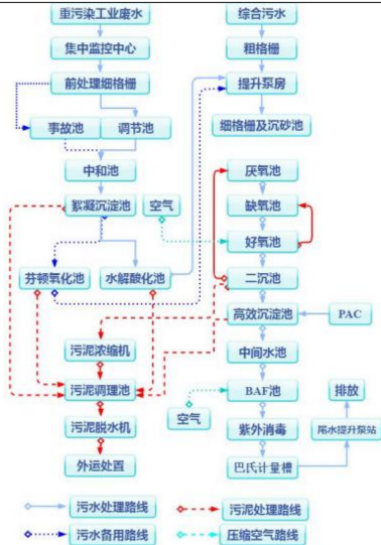
图 4-1 中德金属生态城综合污水处理厂污水处理工艺流程图
